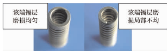
图 2 2 号弹簧两端镉层磨损情况
